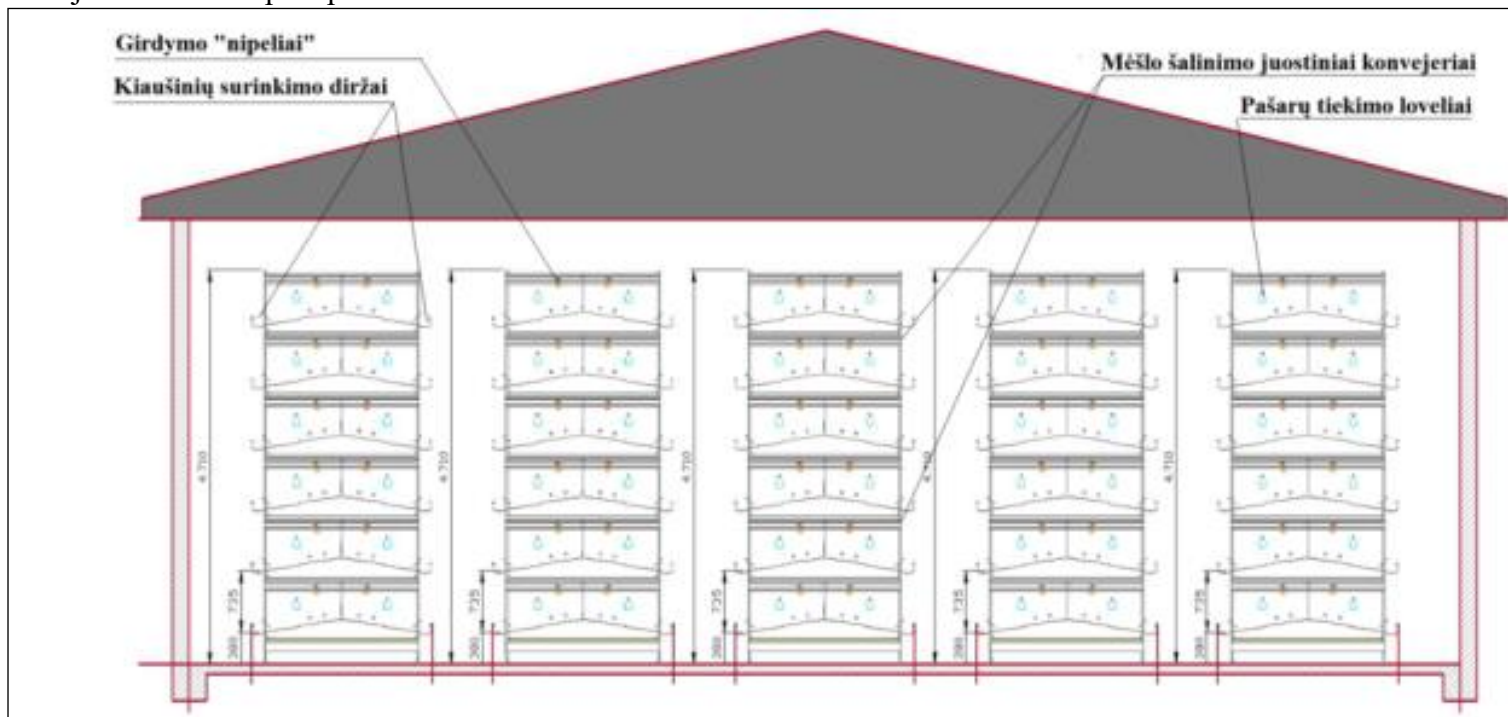
5 Pav. Vištų laikymo narvų išdėstymo vištidėje pavyzdys.
